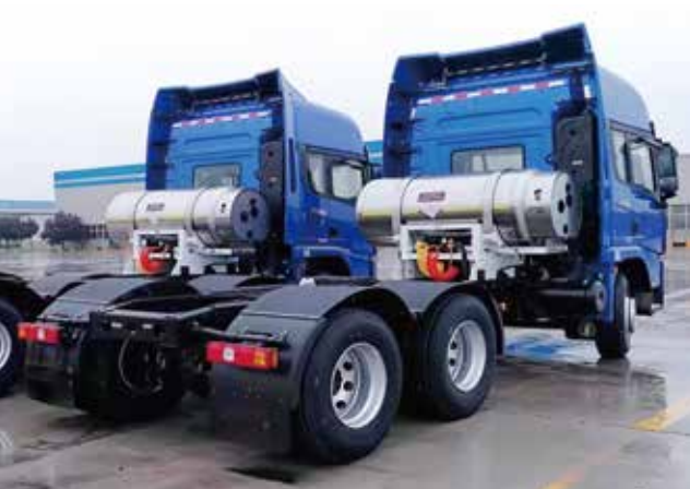
SI型车用LNG系统 SI-type LNG system for vehicles
