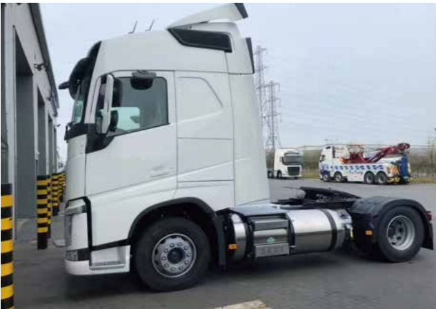
HPDI型车用LNG系统 HPDI type LNG system for vehicles
